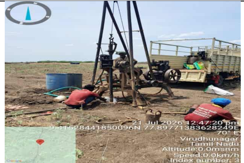
AM-5 0.5 ML D-ELSR SPT Test
